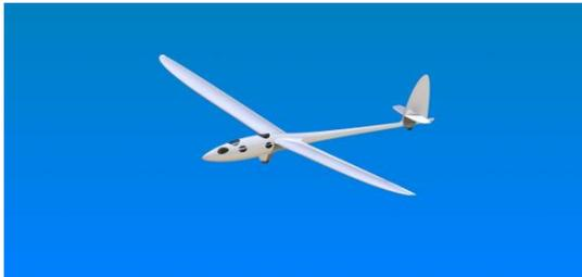
Jim Payne ist Chefpilot des [Perlan II Projekts](#) der Airbus Group. Dieses Projekt hat das Ziel die Stratosphäre mit Hilfe eines Segelflugzeugs zu erkunden. Das Flugzeug mit ca. 25 m Spannweite hat eine Druckkabine und ist darauf ausgelegt in den Wellensystemen der Anden bis zu 90.000 ft (ca. 27.500 m) hoch zu steigen, höher als jedes andere Flugzeug bisher.
